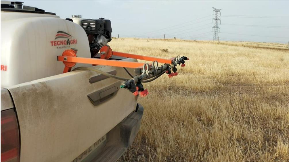
Detalle de la barra pulverizadora de uno de los vehículos utilizados en los tratamientos fitosanitarios
