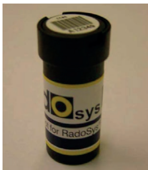
Ilustración 27 - Detector de trazas DTPA
