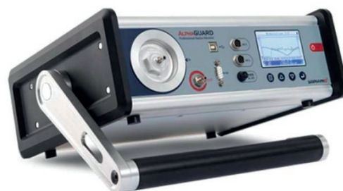
Ilustración 31 - Monitor en continuo de radón MCR
