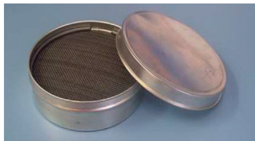
Ilustración 28 - Detector de carbón activo DCA
