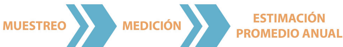
Ilustración 32 - Fases de la determinación del promedio anual de concentración de radón en el aire en los locales habitables de un edificio según el DB HS-6 del CTE
