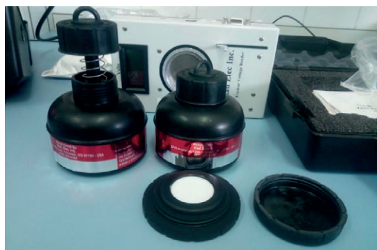
Ilustración 29 - Detector cámara iónica de electret CIE
